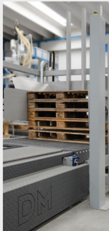
Magazzino pallet automatico, progettato per contenere fino a 15 pallet
