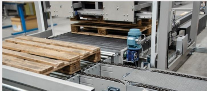
Transfer a 90° per la movimentazione del pallet vuoto verso la stazione di riempimento
