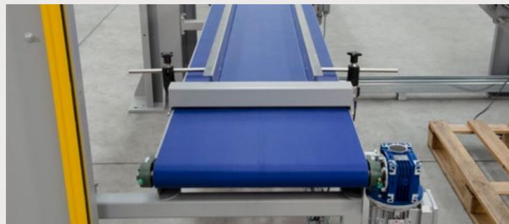
Nastro di alimentazione del palletizzatore dotato di sensori ottici per la lettura delle scatole. In questa stazione i prodotti vengono presentati in modo preciso nella stazione di prelievo
