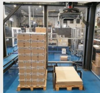
La versione 4 lati aperti dà la possibilità di incrementare il numero di baie, anche con magazzino interfalda o magazzino pallet vuoti.
