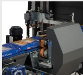
Machine très polyvalente, avec possibilité de l'équiper d'une système de soudure latéral afin d'utiliser différents films et d'obtenir divers types d'emballages avec une même machine.
