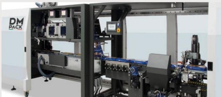
Structure en porte-à-faux facilement accessible, parfaite pour l'entretien et le nettoyage. Différents systèmes d'ouverture (portes à charnières standard, coulissantes en option), sur les deux côtés si besoin.
