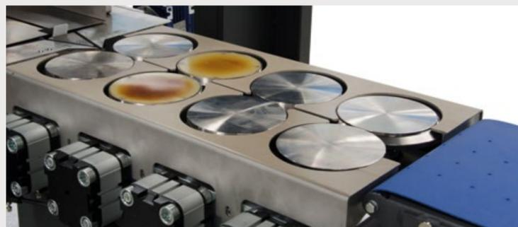
Quatre paires de roues pour souder et plier. Diamètre min. roues 120 mm
