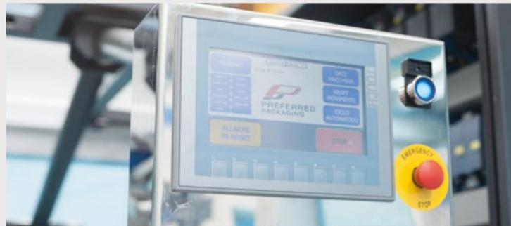
Écran tactile OMRON convivial, avec système de menu de programmes enregistrables à partir de recettes. La plupart des changements de format et des mouvements sont électriques et peuvent être enregistrés et rappelés. La machine est accessible des deux côtés.
