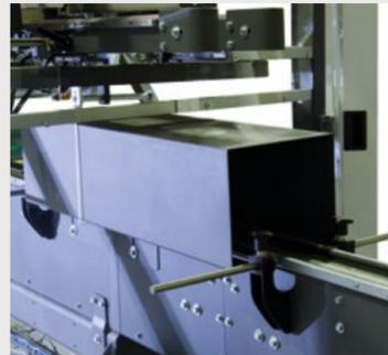
Calage et accélération du convoyeur d'alimentation, avec mécanisme de timing d'entrée fiable pour une efficacité maximale avec un minimum de rebuts.
