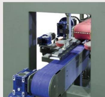
El movimiento continuo y el brazo giratorio preciso recogen las cajas de cartón a través de ventosas y las colocan sobre el producto entrante.
