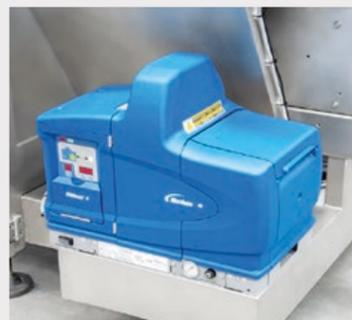
Système de fusion de colle hot melt pour la fermeture des rabats inférieurs Meler, Nordson ou Noxon, à la demande du client.
