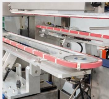
Station de sortie avec courroies à glissière réglables en fonction de la largeur du produit.
