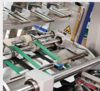
Magasin de découpes avec mécanisme précis de délivrance, parfaitement synchronisé avec le produit qui arrive, équipé de cellule photoélectrique de fin de cartons.
