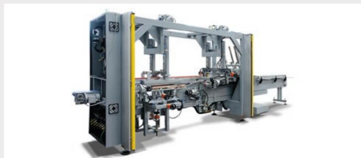
Structure en porte-à-faux complètement accessible pour une maintenance et un nettoyage faciles et rapides sous la machine, construction hygiénique et sanitaire optimale pour le secteur alimentaire. Possibilité d'installer des barrières photoélectriques de sécurité à la place des portes.
