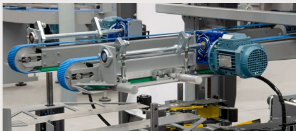
Motore e guide lineari : cambi formati veloci grazie a movimenti motorizzati e precisi grazie alle guide lineari
