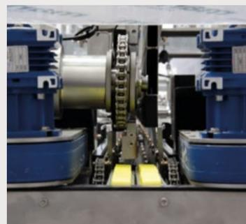
Courroies latérales motorisées garantissant la stabilité du produit en sortie, même à hautes vitesses
