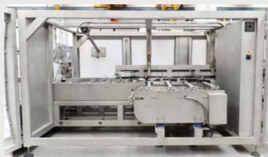
Structure en porte-à-faux complètement accessible au niveau de toutes ses parties, pour un entretien et un nettoyage faciles et rapides. Exécution optimale en termes d'hygiène et de santé
