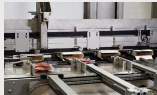
Ouverture des pattes mécaniques, courroies supérieures permettant un transport sûr et stable de l'étui vers la station de sortie.
