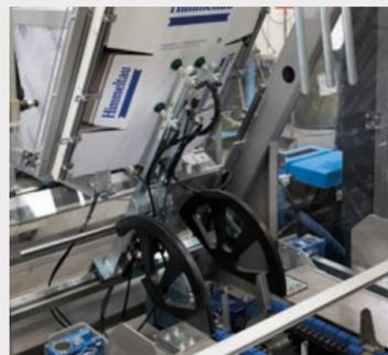
Le stazioni di carico e di srombamento dei cartoni sono montate su guide di scorrimento lineari per una maggiore accessibilità durante le operazioni di manutenzione.
