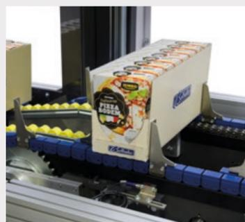
Salida del cartón segura y estable gracias a los transportadores diseñados a medida del producto.
