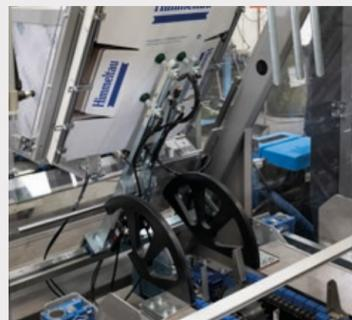
Toma de cajas del amplio almacén con sistema de ventosas, seguro y fiable.
