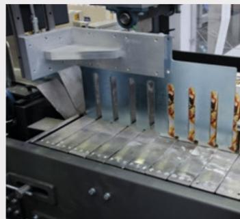
El empujador automático permite agrupar e introducir los productos con precisión en una bandeja o caja.
