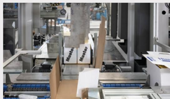
Sistema pick & place preciso y cuidado para colocar el multipaquete en el interior del cartón en formación
