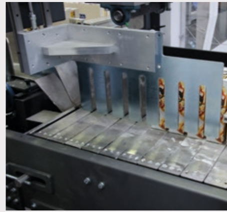
Der automatische Schieber ermöglicht den Produkten, dass sie gruppiert und mit Präzision in der Tray/den Karton abgegeben werden.
