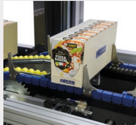
Sicherer und stabiler Ausgang des Kartons durch die auf das Produkt maßgeschneiderten Transportbänder.
