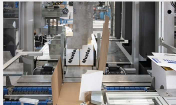
Präzises und genaues Pick&Place-System für die Positionierung des Multipacks im Karton beim Formen.
