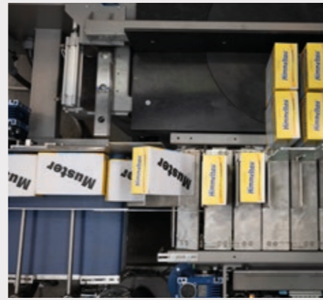
Auf die zu verarbeitenden Produkte zugeschnittenen Lade- und Gruppierungssysteme.
