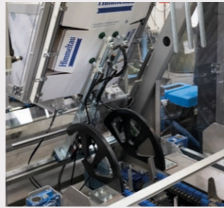
Sichere und zuverlässige Entnahme der Kartons aus dem großen Lager mit einem System aus Saugnapfen.
