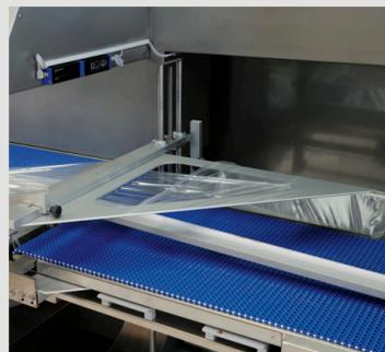
Déroulement du film avec triangle pour film plat ou mono-pli à partir de la bobine. Changement de format rapide et simple sans sachets préformés. Grande polyvalence et gain sur le coût du matériau.
