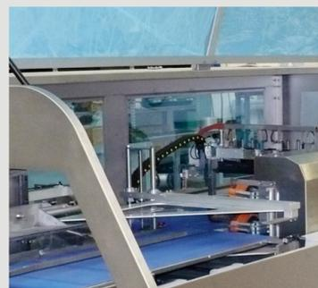
Machine de conditionnement à soudage latéral pour former le sachet. Soudures étanches.
