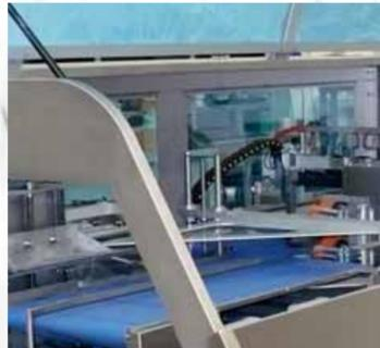
Seitenschweißmaschine mit drei Transportbändern zum Verpacken von Produkten vor dem Vakuumieren. Starke luftdichte Schweißung.
