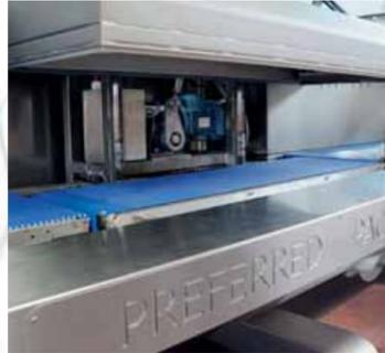
Die Vakuumkammer ist in verschiedenen Maßen erhältlich, abhängig von den Produktmaßen. Verschiedene Zusammenstellungen mit 2/3/4 Kammern für eine höhere Geschwindigkeit oder höheres Vakuum.
