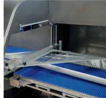
Formschulter für Flach- oder Halbschlauchfolie. KEINE vorgefertigten Beutel. Die Maschine arbeitet in einer Linie mit der Folienspule. Sehr vielseitig und Folienersparnis.
