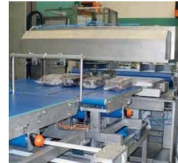
Die Verpackungsmaschine und Vakuumkammern können über Transportbänder und Teilvorrichtungen verbunden werden, abhängig vom Kunden. Aufbau nach Maß.
