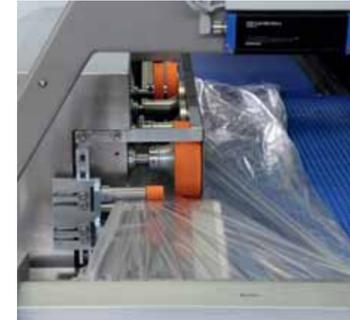
Intralox -Transportband oder einfach abnehmbares Flachtransportband (abhängig vom Produkttyp) für eine einfache Reinigung.
