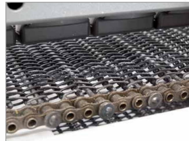
Nastro trasportatore con rete metallica teflonata o a rullini, a seconda della dimensione del tunnel e del tipo di film.
