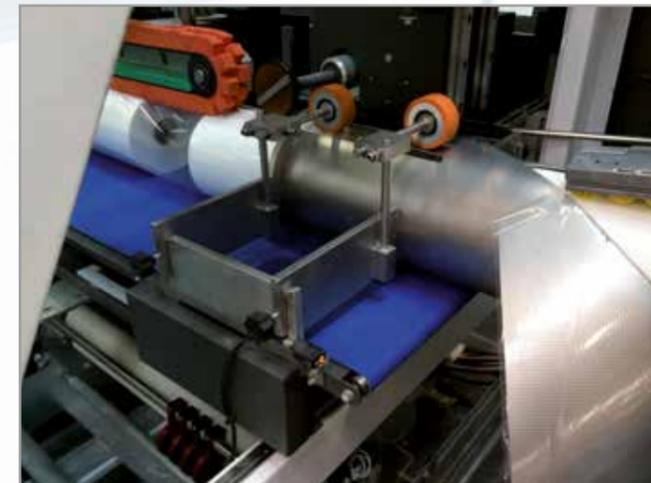
Saldatore doppio. Nella stessa macchina, grazie al tubo formatore, è possibile avere: sistema di saldatura laterale, con sovrapposizione e lap-seal.
