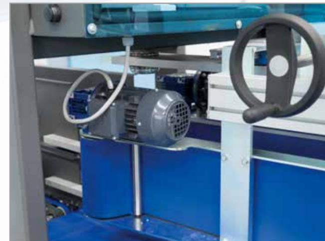
Composto da cinghioi laterali motorizzati per preciso scambio di prodotti e convogliamento nei canali.
