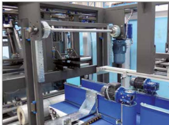
Movimenti comandati e controllati da servomotore per assicurare precisione, affidabilità e minima manutenzione. Cambio formato senza utilizzo di strumenti.
