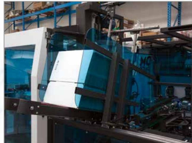
Sistema srombatura cartone motorizzato e sistema per inserimento automatico dei prodotti.
