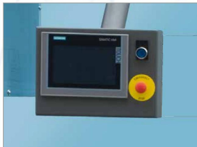
Touch-screen di ultima generazione, ruotabile per operabilità macchina destra e sinistra.
