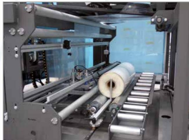
A sbalzo e accessibile da entrambi i lati. Portabobina con carrello per carico facilitato.
