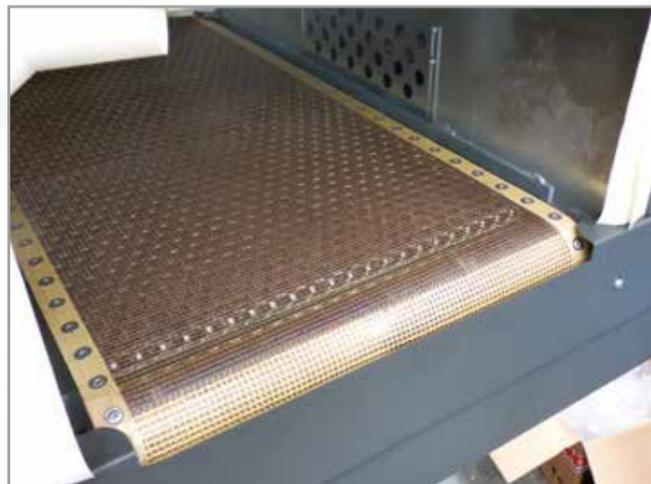
Nastro a rete teflonata a seconda del tipo di film.
