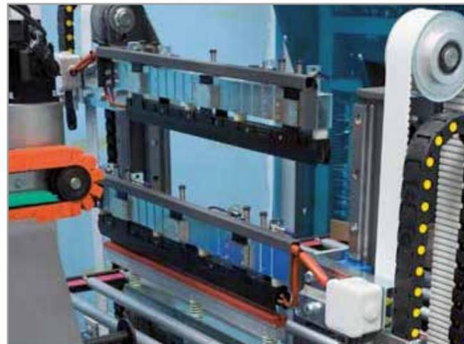
Macchina confezionatrice con doppia barra per alta velocità. Fino a 100 prodotti/min. La doppia barra assicura la velocità e l'elevata performance senza sforzo per i componenti meccanici. Disponibile versione "lap seal"/saldatura superiore e sovrapposizione.
