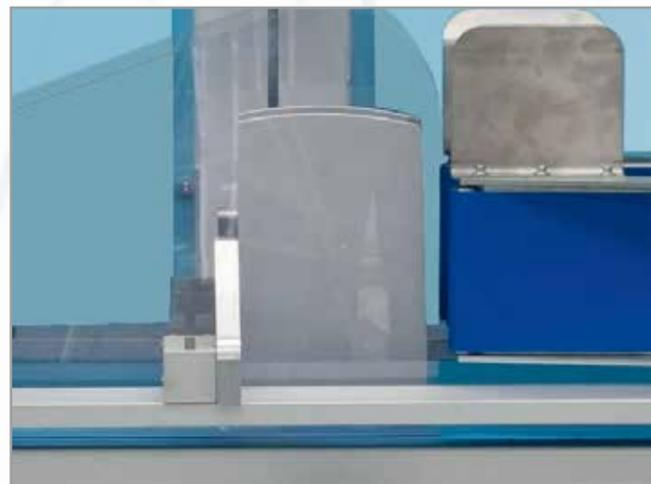
Sistema di rotazione a Stella con motore brushless-servo che permette il controllo della posizione del prodotto durante tutti i 90° di movimento rotatorio.
