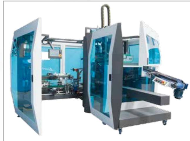
Nuovo desing ergonomico. Tutte le parti della macchina sono facilmente accessibili grazie alle innovative porte scorrevoli apribili. Il modulo di alimentazione può essere facilmente separato dalla macchina cartonatrice per il cambio formato.
