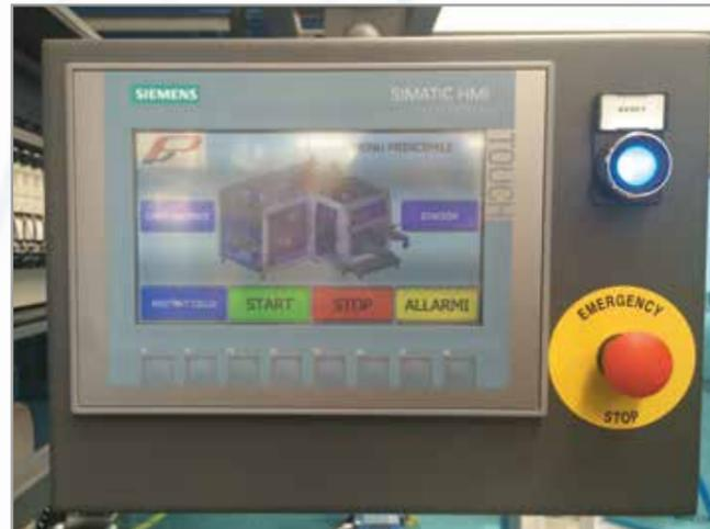
Macchina gestita da PLC Siemens e touch-screen intuitivo. Cambio formato auto regolabile.
