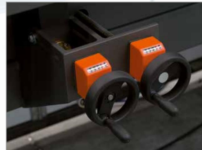
Regolazioni per cambio formato, possibili con volantino a righe metriche o con sistema completamente automatico con motore. Posizioni memorizzabili su touch-screen.
