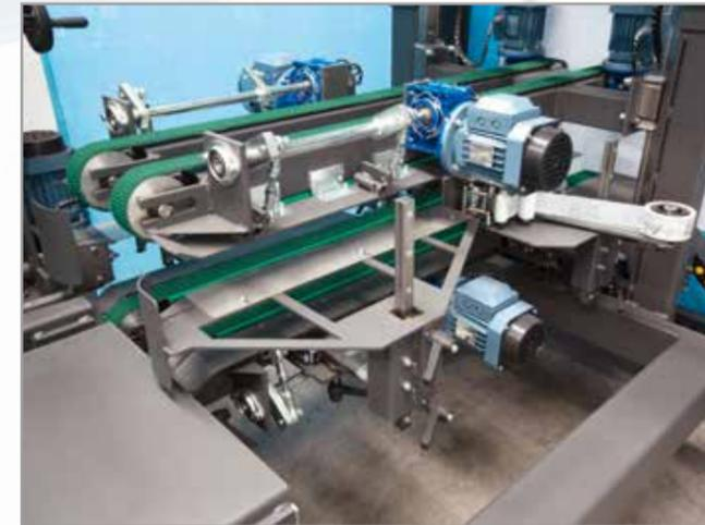
Chiusura automatica del cartone con nastro adesivo o colla a caldo. Guide laterali motorizzate. Regolazione automatica.
