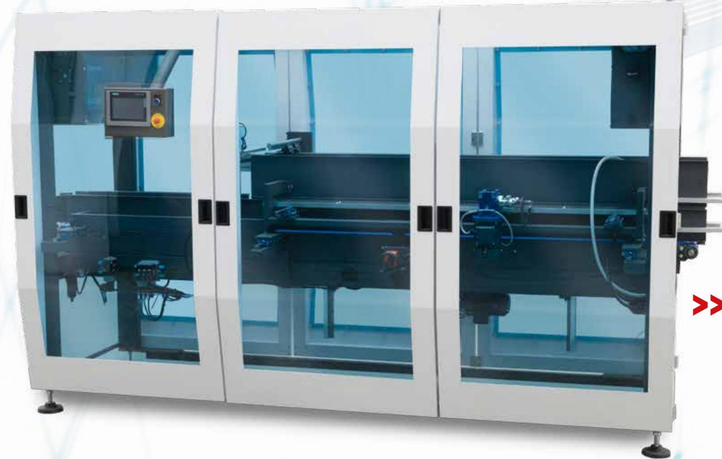
»» Sistema per impilare i prodotti su più livelli: totalmente meccanico con ascensore e palette laterali meccaniche motorizzate.
