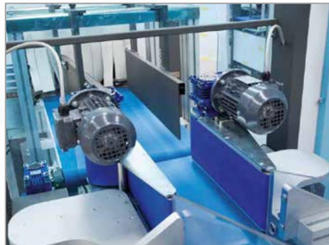
Composto da cinghioi lanciatori laterali motorizzati per indirizzare i prodotti in sicurezza nel cuore della macchina.
