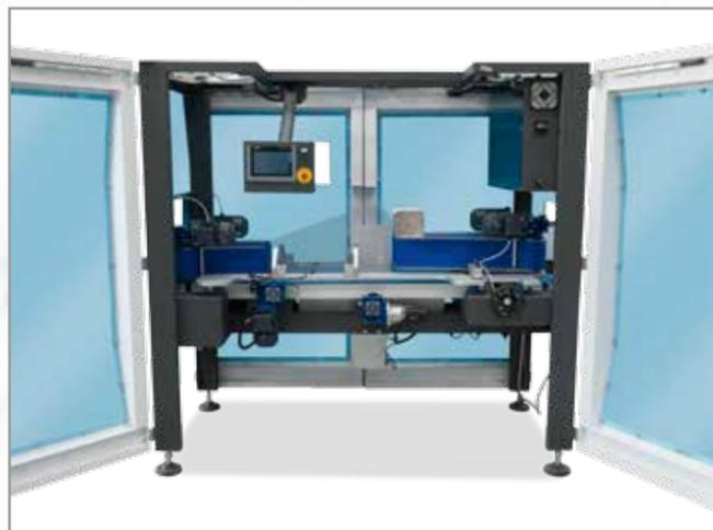
Regolazione larghezza possibile da entrambi i lati o con volante e sistema metrico, o con sistema automatico con motore memorizzabile e richiamabile da touch-screen (a ricetta).
