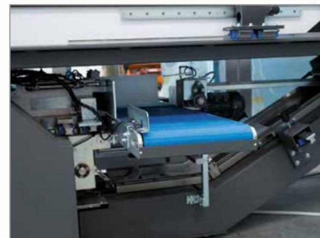
Facilmente estraibile grazie alla costruzione montata su guide lineari di scorrimento.
