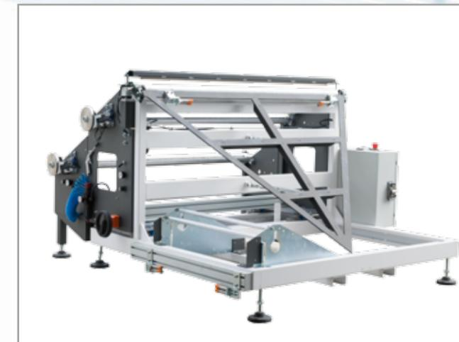
Monopiegatore esterno, singolo o doppio, per veloce cambio bobina: semiautomatico con congiungimento di una bobina con l'altra, grazie ad una barra saldante attivata manualmente o in versione completamente automatica, senza stop macchina.
