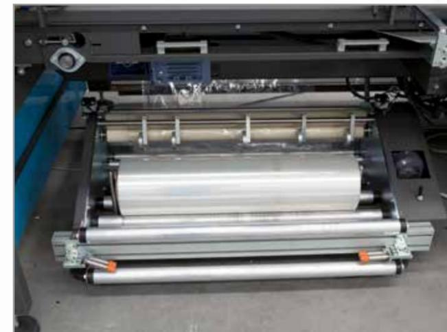
Portabobina estraibile, per veloce cambio bobina. Lavora con film poliolefina e polietilene, monopiega o piano (con monopiegatore esterno doppio o singolo).
