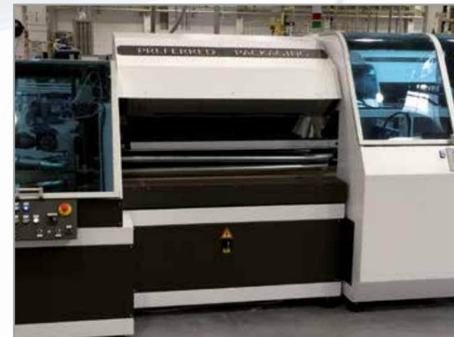
Sistema di termoretrazione standard con resistenze o speciale con leister. Perfetto con film stampato. Evita la deformazione della stampa del film.
