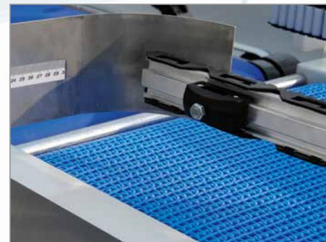
Tappeto Intralox e volano per un veloce cambio formato mediante righe metriche.
