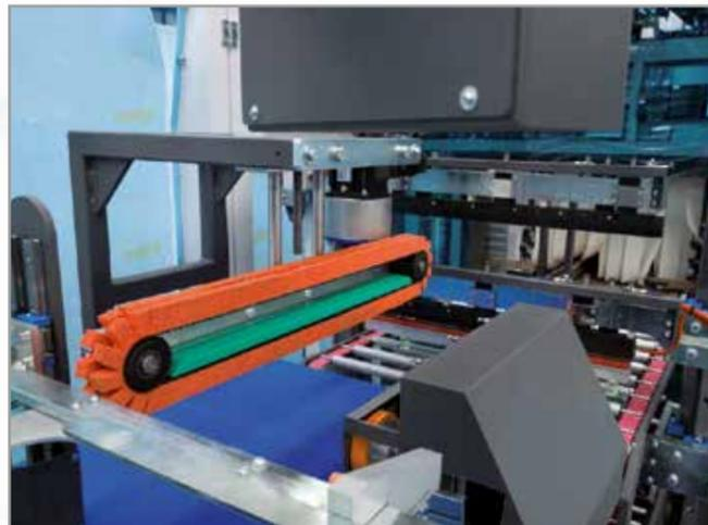
Cinghio superiore motorizzato: assicura la stabilità ed il controllo ad alte velocità oltre a permettere di bloccare etichetta e prodotto.
