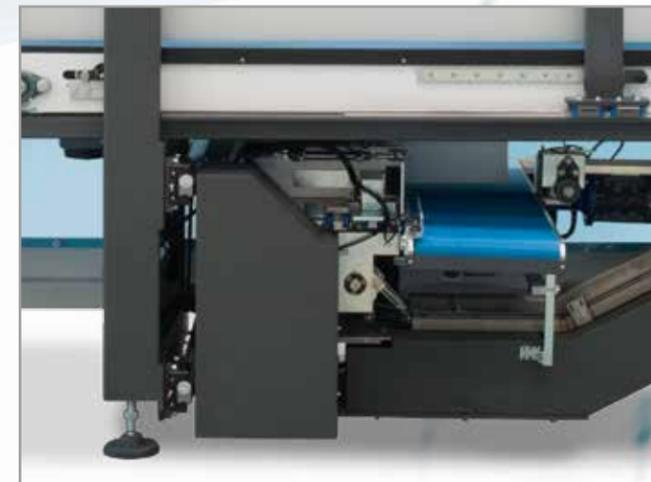
Applicatore di etichette da sotto permette l'inserimento in automatico dell'etichetta ad alta velocità tra il prodotto ed il film, con doppie pinze motorizzate per garantire la presa dell'etichetta. L'applicatore è equipaggiato di un nastro a facchinetti motorizzato che assicura l'allineamento del prodotto in arrivo dal nastro sovrastante.
