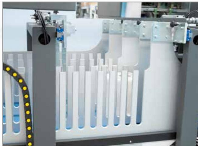
Canali facilmente regolabili con pomelli per la creazione del multimballo. Disponibile versione automatica con motore per cambio formato immediato senza regolazioni manuali, cambio formato da touch con ricetta.
