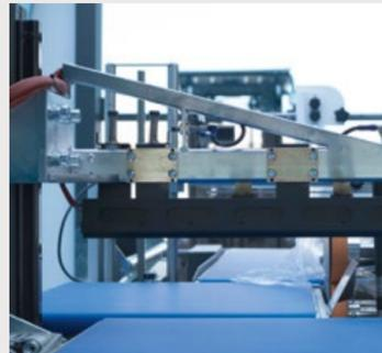
Le convoyeur central mobile permet aux produits de toujours circuler au centre. Inutile de déplacer le tunnel de rétraction ou le convoyeur d'alimentation.
