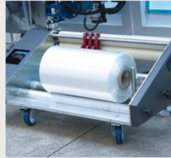
Unité de distribution de film amovible. Pour une insertion facile et un changement rapide du film. La machine fonctionne en général avec un film plié en son centre mais peut aussi travailler avec un film plat en option.
