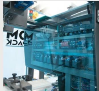
Armoire électrique visible. Sa position en hauteur est parfaite pour l'entretien réalisé par l'opérateur.
