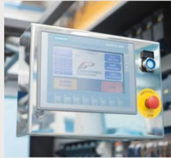
Écran tactile intuitif pour un changement de format facile. En option, l'écran tactile est réglable en 3 positions différentes, permettant à l'opérateur de travailler et d'accéder à la machine des deux côtés. La direction standard de la machine est de droite à gauche (gauche à droite en option).
