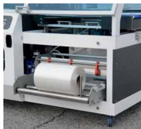
Unidad de desbobinado y recogedor de sobrante en zona frontal con puerta corredera, fácil acceso y movimiento. Desbobinador extraíble.
