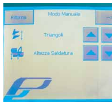
Cambio de formato fácil: Altura de soldadura y triangulo motorizados. Altura hasta 400 mm.
