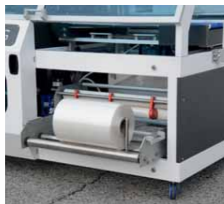
Folienlager und Einheit für die Folienabfallaufwicklung befinden sich beide vorne an der Maschine und sind somit leicht zugänglich. Äußerst benutzerfreundlich. Schiebetür.
