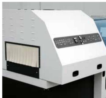
Nel tunnel integrato con la macchina a saldatura angolare la camera è spostabile in modo che il prodotto lavori sempre in centro, mentre nella nuova generazione di tunnel la camera è fissa in quanto il centraggio del prodotto è mantenuto dal nastro centrale della macchina a saldatura laterale Star Evo.
