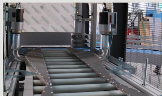
Sistema di termoretrazione standard con resistenze o speciale con leister. Perfetto con film stampato poiché evita la deformazione della stampa del film.
