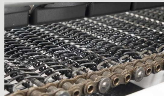
Nastro trasportatore con rete metallica teflonata o a rullini, a seconda della dimensione del tunnel e del tipo di film.
