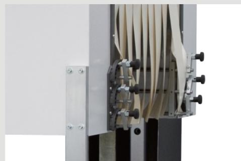
Regolazione flusso aria con inverter indipendenti (uno per ogni camera). Flap che si aprono e si regolano per una migliore ventilazione e di conseguenza una migliore termoretrazione, regolabili dall'esterno.
