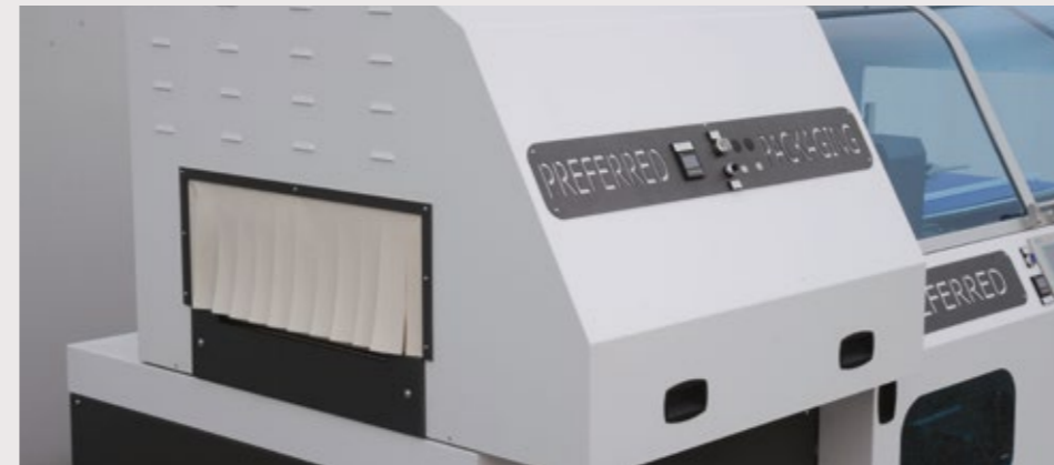
Sur cette version de tunnel (intégré à la soudeuse automatique en L), la chambre est mobile pour que les produits circulent toujours au milieu, alors que sur le tunnel EVO nouvelle génération, le tunnel est fixe puisque le centrage des produits est assuré sur le convoyeur central de la soudeuse latérale EVO.
