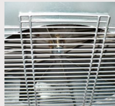
Le ventilateur du moteur est protégé et facile à extraire.
