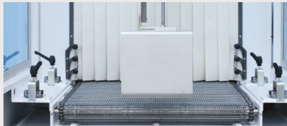
Le tunnel peut être équipé d'un compacteur de produits afin de garantir leur parfait alignement avant rétraction.
