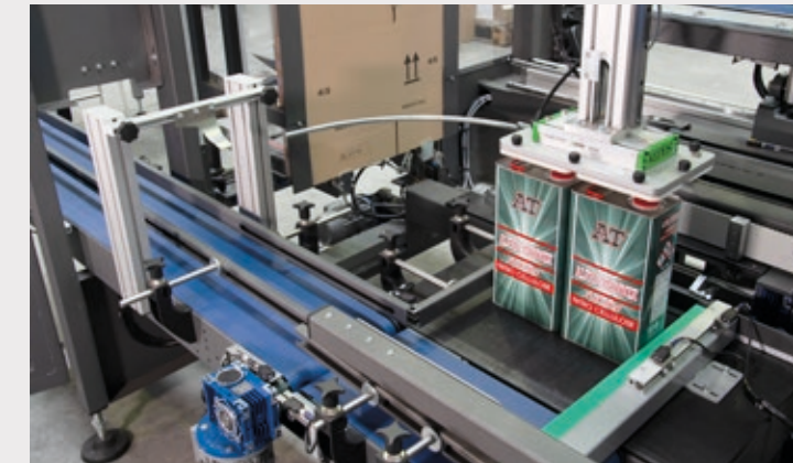
Entièrement accessible et ouvrable grâce à sa structure en porte-à-faux.
