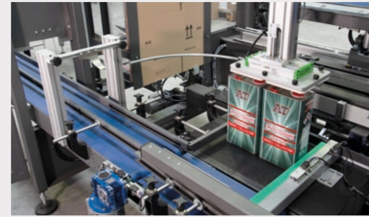
Se puede acceder y abrir completamente gracias a la estructura en voladizo.
