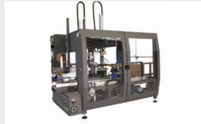
Kartonverpackungsmaschine der neuen Generation, einzigartig in ihrer Art. Kompakt, automatisch, einfach einzustellen, überwiegend motorbetrieben).
