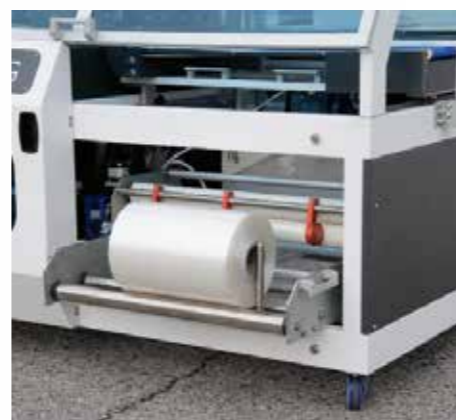
Unità svolgibobina e raccogli-frido entrambi posti frontalmente con porta scorrevole, facili da raggiungere. Svolgibobina estraibile.
