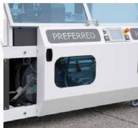
Unità svolgibobina e raccogli-frido entrambi posti frontalmente con porta scorrevole, facili da raggiungere. Svolgibobina estraibile.
