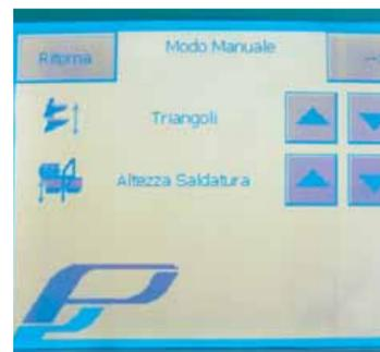
Fácil cambio de formato: Altura de soldadura y triangulo motorizado. Altura hasta 400 mm.
