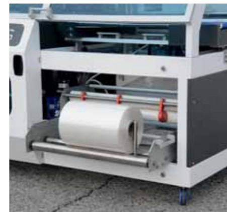
Folienlager und Einheit für die Folienabfallaufwicklung befinden sich beide vorne an der Maschine und sind somit leicht zugänglich. Äußerst benutzerfreundlich. Schiebetür.
