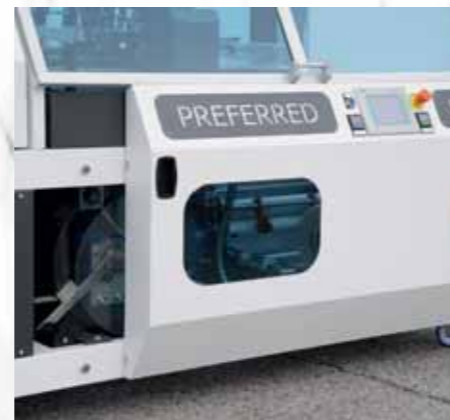
Folienlager und Einheit für die Folienabfallaufwicklung befinden sich beide vorne an der Maschine und sind somit leicht zugänglich. Äußerst benutzerfreundlich. Schiebetür.
