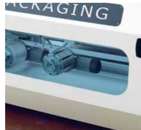
Doppia porta bobina per bobine di cartone. Optional: maniglie su bobina.
