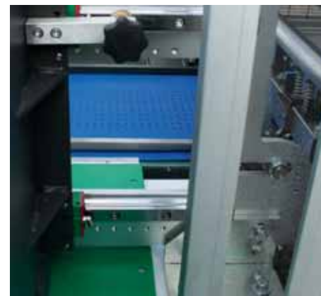
Todos los movimientos son guiados con ajustes con manillas o pomos para una fácil regulación y ajuste.
