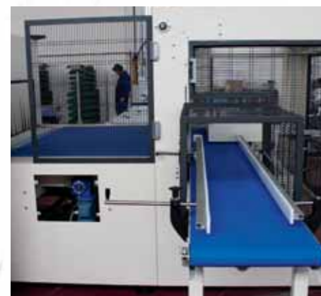
La máquina puede ser instalada con una banda a 90° y empujador para un enfajado de mayor velocidad y más compacto.
