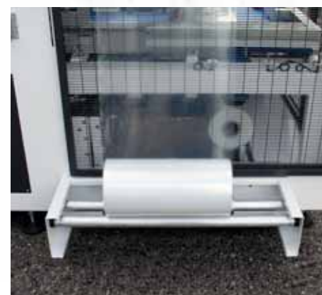
Las dos bobinas en la parte inferior para un fácil y cómodo cambio.
