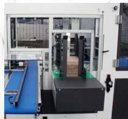
90°-Ausführung für automatische Anordnung und Beschickung. Unterschiedlicher Aufbau für die Produktzufuhr sowohl von links oder von rechts möglich.
