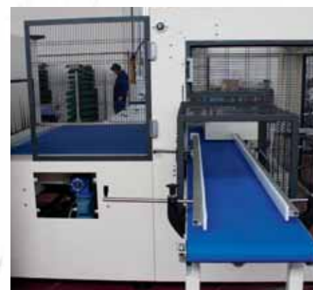
Die Maschine kann mit einem Zuführtransportband ausgestattet werden. 90°-Transportband mit Stoßzuführvorrichtung für höhere Geschwindigkeit sowie die automatische Erstellung verschiedener Gebinde.
