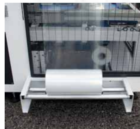
Beide Spulen befinden sich für eine einfache Beschickung unten.
