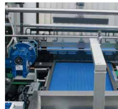
Motorisierter Schweißstempel und motorisierte Stoßzuführreinrichtung.
