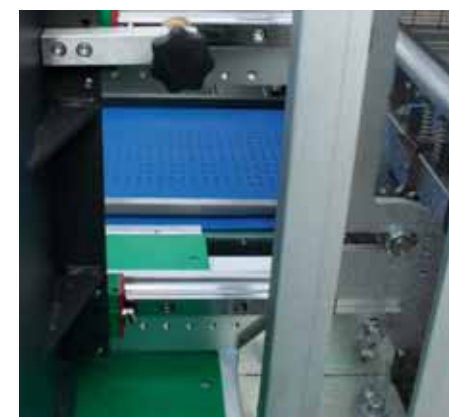
Einfaches Verstellen mit Hiwin-Profilschienenführungen.
