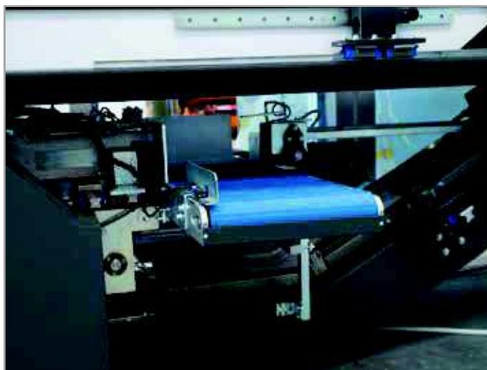
Facilmente estraibile grazie alla costruzione montata su guide lineari di scorrimento.
