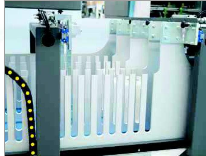
Canali facilmente regolabili con pomelli per la creazione del multimbello. Disponibile versione automatica con motore per cambio formato immediato senza regolazioni manuali, cambio formato da touch con ricetta.
