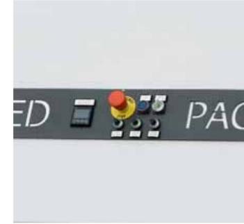
Comodo panel de mandos desde el que se puede ajustar temperatura, velocidad del transportador y velocidad de soplado.
