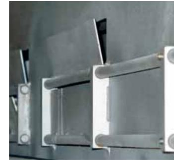
Flap internos ajustables para conseguir aumentar o disminuir el flujo de aire interno para controlar la retracción óptima del producto.
