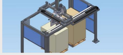
Systèmes de magasin de plates-formes disponibles Tapis d'alimentation du Palettiseur équipé de capteurs optiques pour la lecture des boîtes. Dans cette station, les produits sont présentés de manière précise
