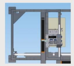
Systèmes de tapis à rouleaux disponibles pour le chargement automatique et le déchargement automatique de la plate-forme vide et pleine
