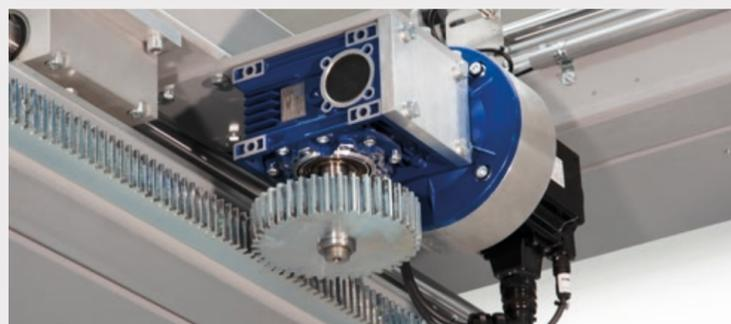
L'utilisation de moteurs sans balais permet une haute précision de positionnement des colis
