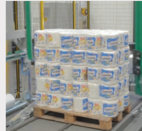
Banderoleuses stretch wrapper automatiques avec protections périphériques, disponibles aussi avec unité de soudage, pré-extenseur et applicateur de protection.
