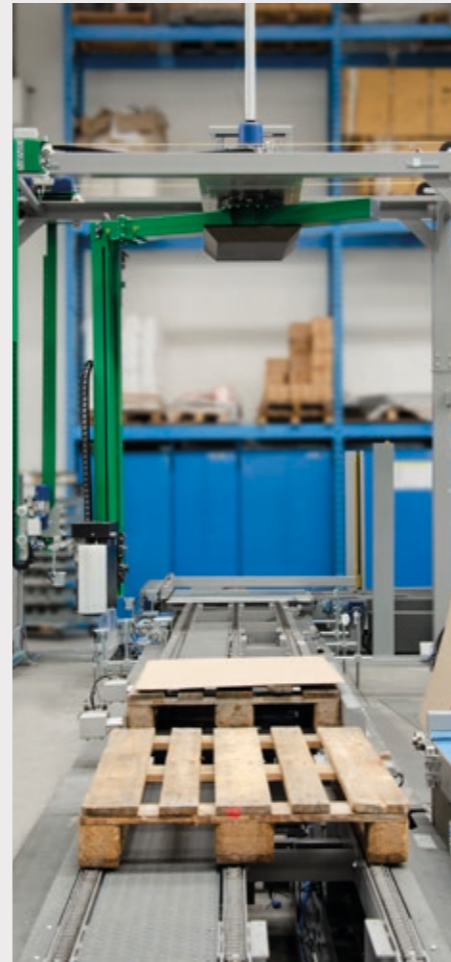
Convoyeurs à rouleaux motorisés pour stockage et transport de palettes vides et pleines
