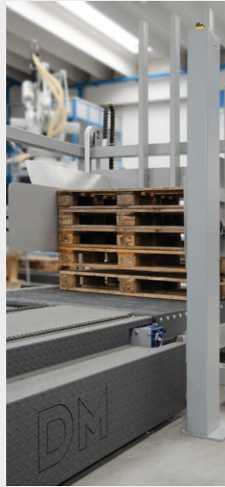
Magasin de palettes automatique, d'une capacité maximale de 15 palettes
