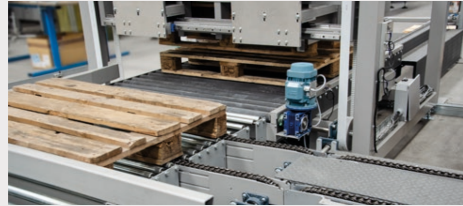
Convoyeur à 90° pour manutention de la palette vide vers le poste de remplissage
