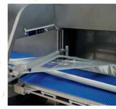
Desbobinador de film com triangula que puede trabajar com film lámina o semitubo. Rápido y sencillo cambio de formato, sin bolsa preformada. Gran versatilidade y ahorro en el consumo de film.
