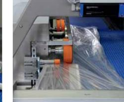
Banda entrada intralox alimentaria o banda lisa con fácil desmontaje (dependiendo del producto) óptima para la limpieza.
