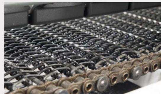
Cinta transportadora con rejilla metálica teflonada o de rodillos, dependiendo de la dimensión del túnel y del tipo de película.
