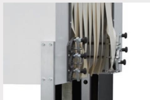
Regulación del flujo de aire con inverter, independientes (uno en cada cámara). Flaps que se abren y se regulan para una mejor ventilación y en consecuencia una mejor termorretracción, se pueden regular desde el exterior.
