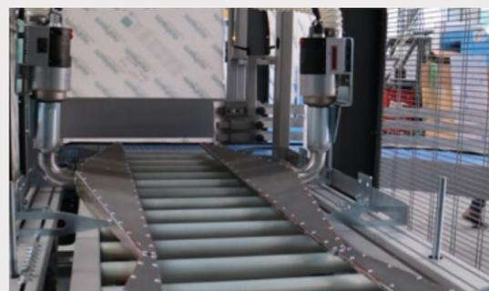
Sistema de termorretracción estándar con resistencias o especial con Leister. Perfecto con película impresa ya que evita que se deforme la impresión de la película.
