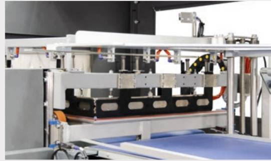
Der vertikale Einzelbalken, der überall den gleichen Druck auf die Folie ausübt, ersetzt die alten Scherenarme und gewährleistet eine gleichmäßigere Schweißnaht. Balkenbreite nur 1 cm. Weniger Folie am Produkt. Weniger Energieverbrauch bei der Schrumpfung.
