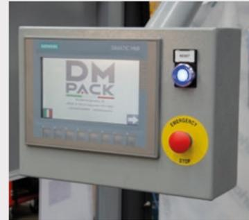
Pantalla táctil para una cómoda interfaz de operador en la lectura y programación de los parámetros de máquina. Capacidad de memorizar hasta 25 programas diferentes
