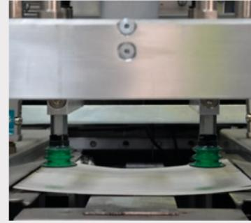
Sistema de ventosas para el posicionamiento preciso y exacto del troquel antes de la formación
