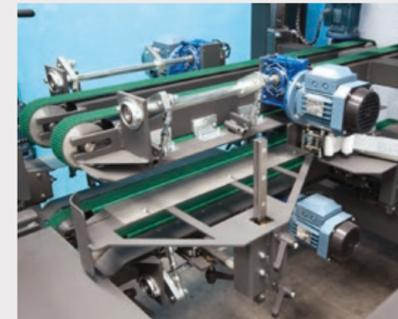
Automatische Kartonverschließung mit Klebeband oder Heißkleber als Sonderausstattung. Motorbetriebene seitliche Führungsschienen. Automatische Einstellung.
