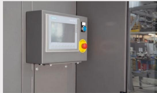
Maschinensteuerung über Siemens- oder OMRON-SPS und intuitivem Touchscreen. Über das Bedienfeld leicht einstellbarer Formatwechsel.
