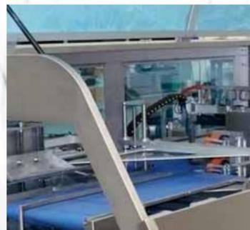
Macchina confezionatrice a saldatura laterale per formare il sacchetto. Saldature a tenuta.
