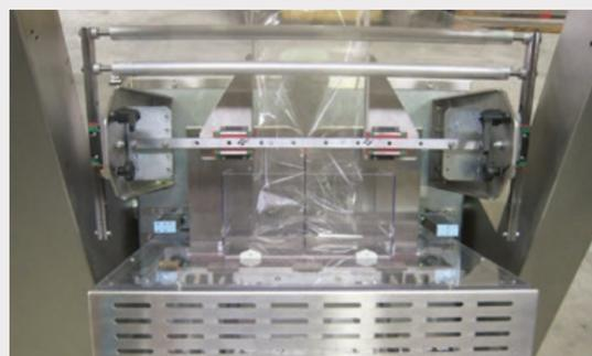
Plateau inclinable de 0° a 90° et lecture précise du produit à l'aide d'une photocellule à barrière.
