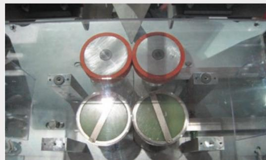
Roues soudantes pour soudage et tension du Film.
