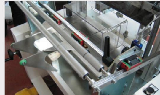
Un túnel adaptable permite el envasado de muchos tipo de productos diferentes con una amplia GAMA de medidas.
