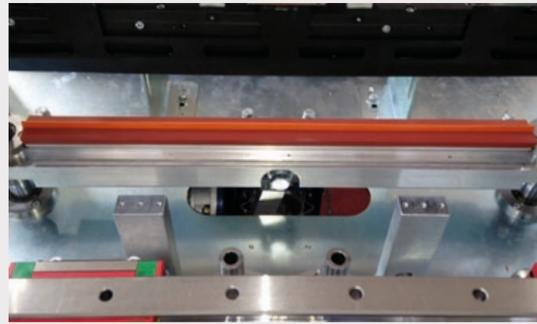
Barra de soldadura motorizada que se puede utilizar para película PE y BOPP.
