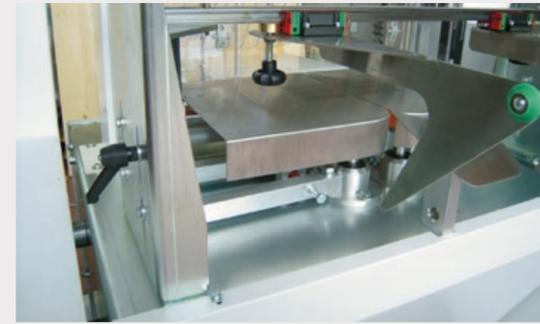
Medida de la bolsa regulable. Todos los movimientos sobre guías lineales.
