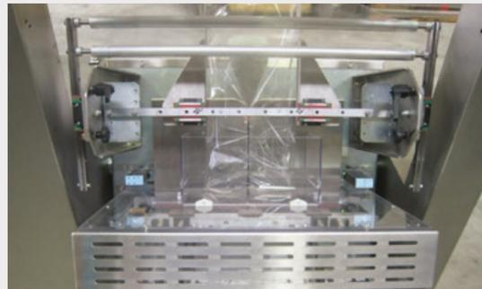
Plano inclinable de 0° a 90° y lectura de producto precisa mediante fotocélula de barrera.
