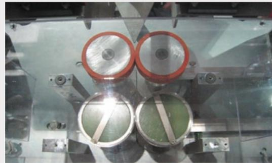
Ruedas de soldadura para soldadura y tensado de la película.
