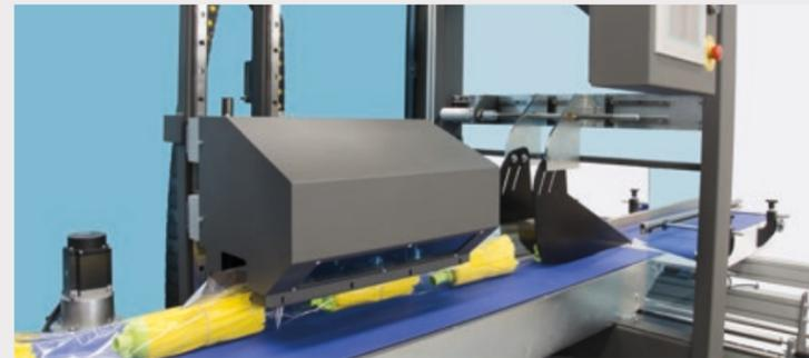
Costruita sulla stessa struttura e con la stessa filosofia, la nostra Flowpack monta il saldatore superiore o inferiore (bobina dal basso o dall'alto) al posto del saldatore laterale.
