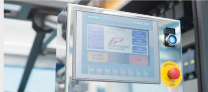
Touch screen intuitivo per un semplice cambio formato. Il touch screen può ruotare in 3 diverse posizioni per permettere all'operatore di lavorare da tutti i lati della macchina: fronte, retro e lato.
