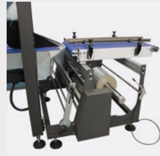
Svolgibobina con bobina singola o doppio posto bobina con barra saldante di congiungimento per veloce cambio film.
