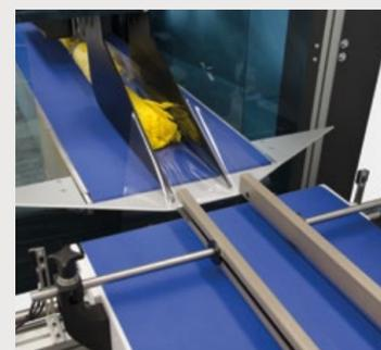
Le triangle de formage est motorisé et réglable depuis l'écran tactile du film (dit conformateur).
