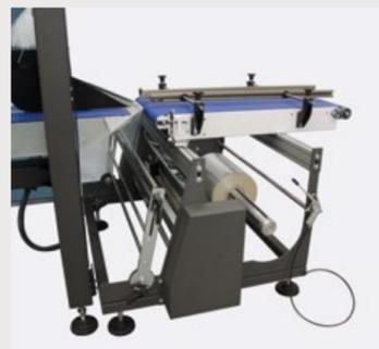
Distributeur de film de série ; double distributeur de film avec barre de soudure pour un changement de film rapide en option.
