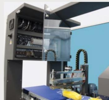
Tableau électrique visible, parfaitement accessible à l'opérateur, grâce à sa position en hauteur.
