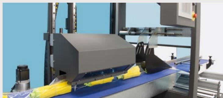
Cette machine flowpack est équipée d'une soudeuse supérieure (bobine dessous).
