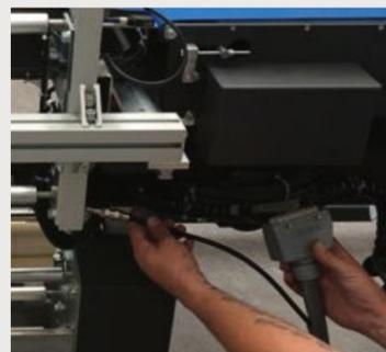
Les connecteurs permettent un raccordement rapide afin de réduire le temps de travail de l'opérateur.
