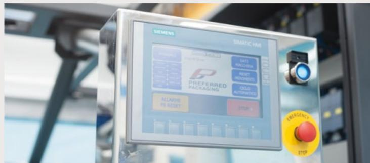
Écran tactile intuitif pour un changement de format simple. Rotatif sur 3 positions différentes pour que l'opérateur puisse travailler sur les deux côtés.
