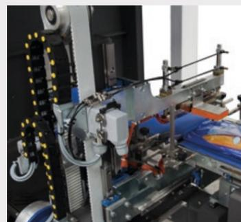
Barra saldante motorizzata equipaggiata di sistema gusseting.
