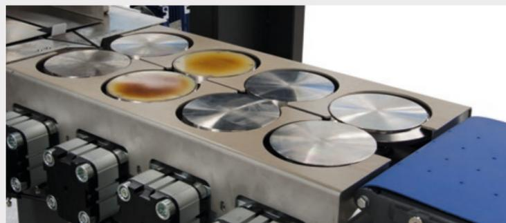
Quattro coppie di ruote per saldare e piegare la pinna- diametro delle ruote min. 120mm.
