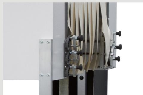
Luftstromeinstellung mit unabhängigem Inverter (einer pro Kammer). Für eine optimale Belüftung sind Klappen vorhanden, die geöffnet und von außen eingestellt werden können, um ein optimales Schrumpfergebnis zu erzielen.
