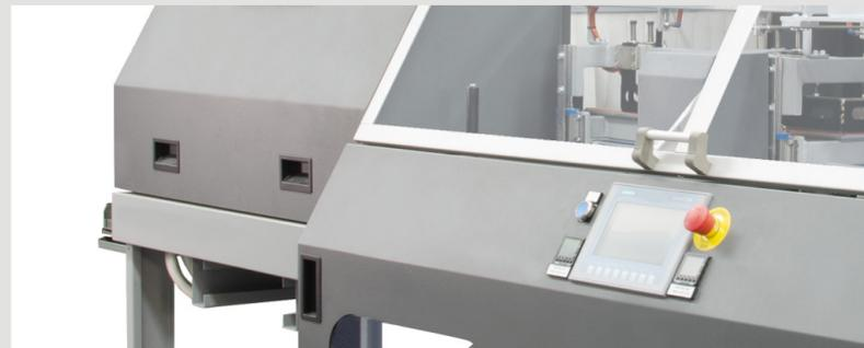
Bei den COMBO-Ausführungen unserer FLO Winkelschweißer kann die Schrumpfkammer der Tunnel mithilfe der vorne befindlichen Griffe horizontal verschoben werden, um sie auf die aus der Verpackungsmaschine kommenden Produkte auszurichten. So wird ein optimales Schrumpfergebnis erzielt, ohne dass der gesamte Tunnel verschoben werden muss. Eine Sonderausstattung, die bei der „EVO“ nicht mehr notwendig ist, bei der das Produkt immer zentral befördert wird.
