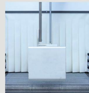
Erhältliche Sonderausstattung: Glattstoßvorrichtung für das Ausrichten von Multipacks.
