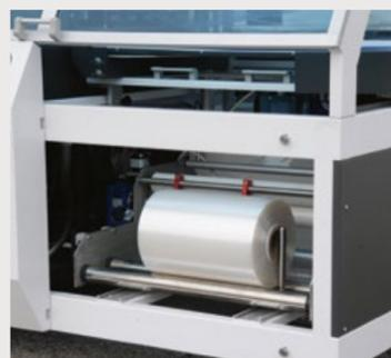
Distributeur et unités de reboinage de film facilement accessibles grâce à la position frontale et à la porte coulissante.
