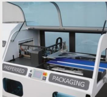
La barre verticale en L garantit une pression constante sur le film, en remplaçant l'ancien système en ciseaux.
