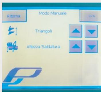
L'écran tactile intuitif permet de changer facilement de format, de centrer le soudage et de régler la hauteur du triangle de formage.
