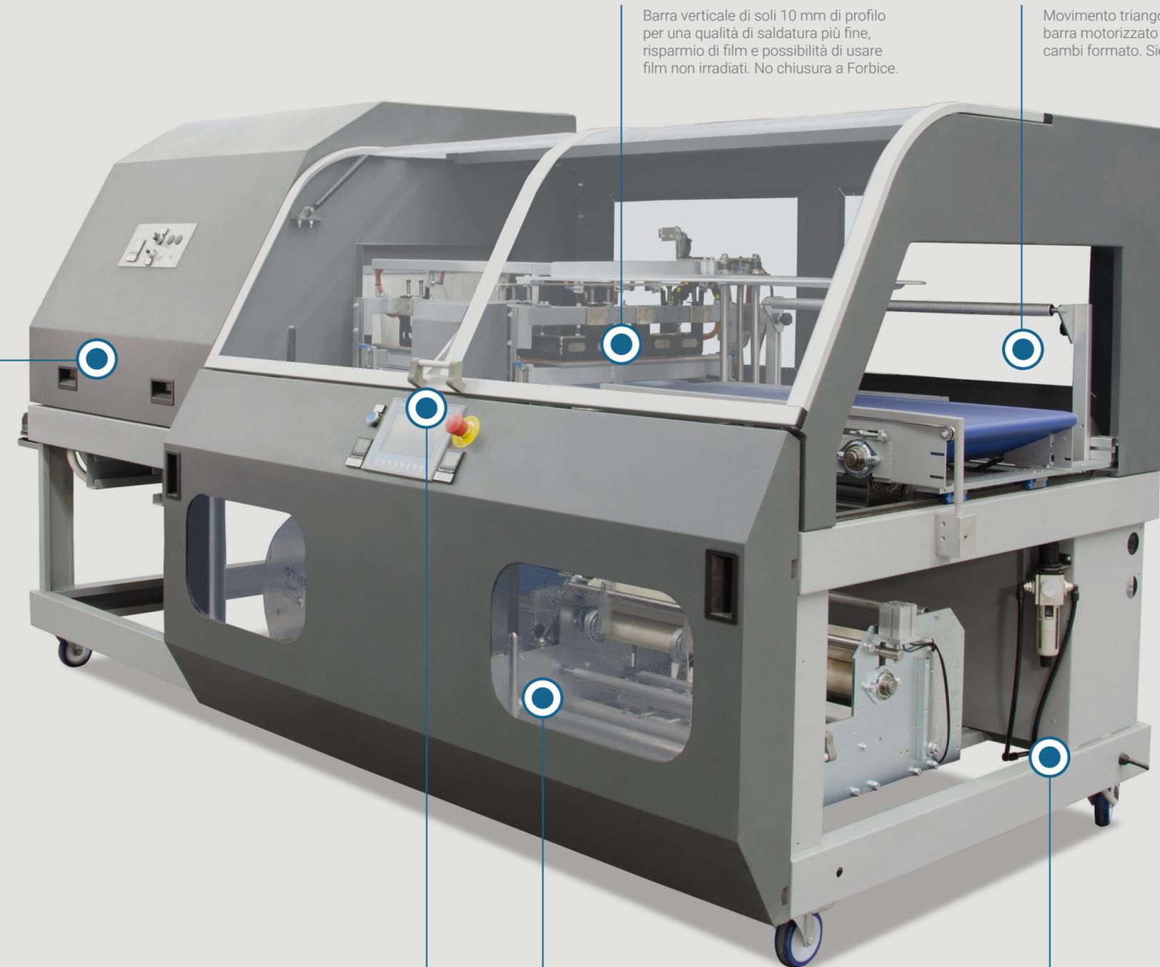
Barra verticale di soli 10 mm di profilo per una qualità di saldatura più fine, risparmio di film e possibilità di usare film non irradiati. No chiusura a Forbice.
