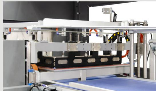
La barra unica verticale, che garantisce la stessa pressione su tutti i punti del film, sostituisce la vecchia barra a forbice, per una saldatura più uniforme. Larghezza barra di solo 1 cm. Meno film sul prodotto. Meno consumo energetico in termoretrazione.
