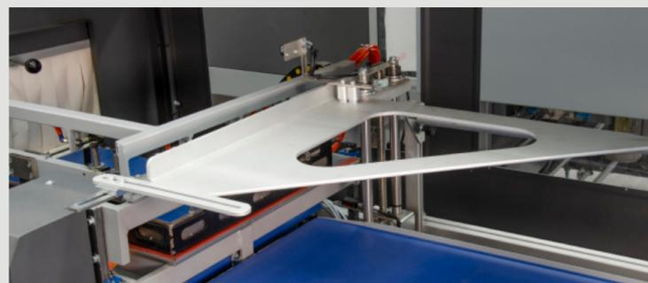
Facili cambi formato: centro di saldatura e triangolo motorizzato. Altezza fino a 400 mm.
