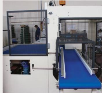
La machine peut être équipée d'un convoyeur en ligne ou à 90° avec poussoir pour une vitesse supérieure ainsi que pour la réalisation automatique de multipacks.
