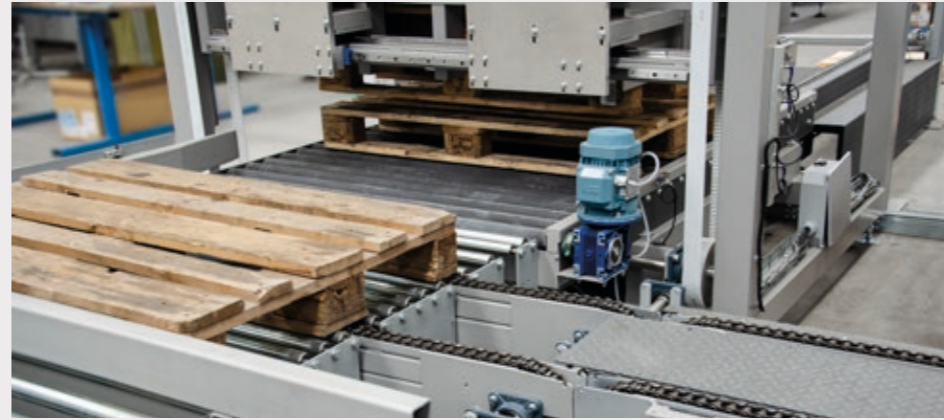
transferencia de 90° para el desplazamiento del palet vacío hacia la estación de llenado
