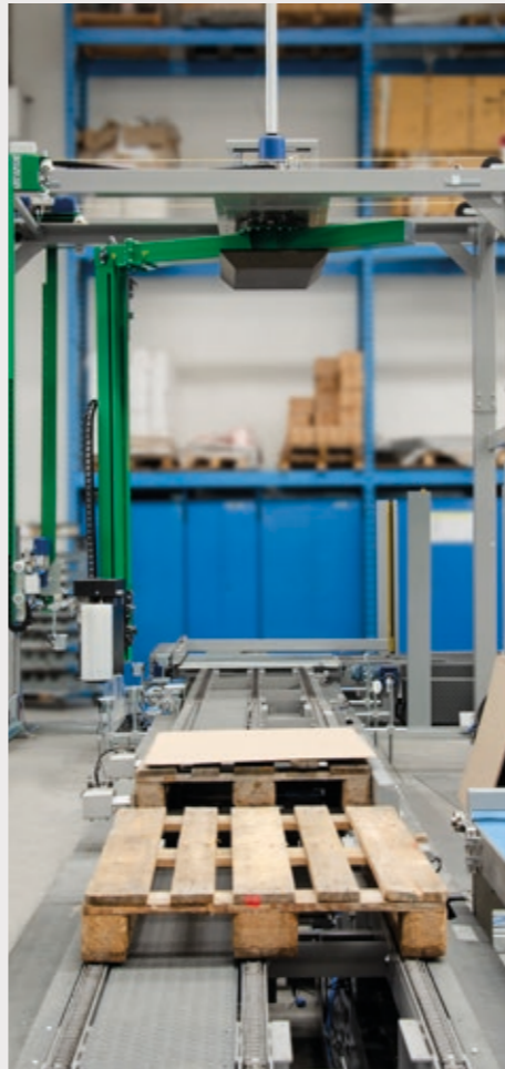
Transportadores de rodillos motorizados para acumulación y transporte de palets vacíos y llenos
