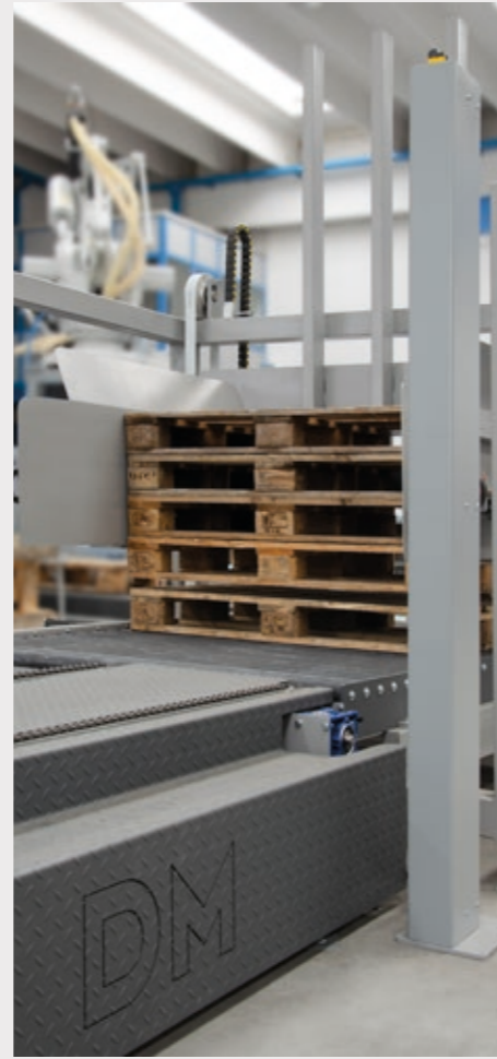
Almacén de palet automático, diseñado para contener hasta 15 palet
